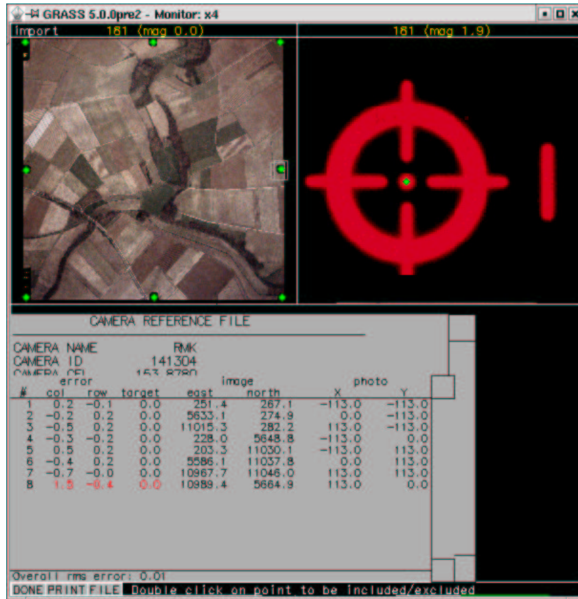
Abbildung 9.2.: Analyse der Genauigkeit der Rahmenmarkenidentifizierung in GRASS
